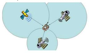
En effet, notre récepteur GPS capte les signaux de trois satellites au minimum et en calculant le temps de propagation de l'onde radio qui se propage à la vitesse de
